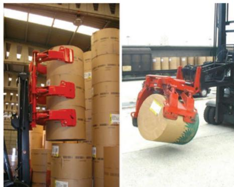
provoca l'ovalizzazione delle bobine di carta. Il controllo della forza di serraggio può diventare impegnativo da gestire per il carellista, poiché per ogni bobina possono cambiare la qualità della carta, le dimensioni, il peso ed il diametro delle bobine.
