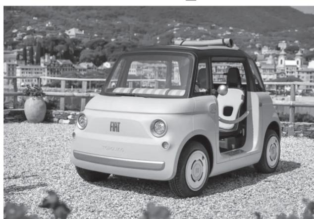
in after market) ma buone finiture e un motore la cui batteria al litio si ricarica dalla presa di corrente domestica in circa 3 ore, con una autonomia di quasi 100 km e una
