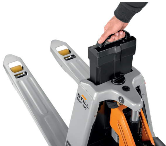
Nella foto: L'estrazione della batteria.
