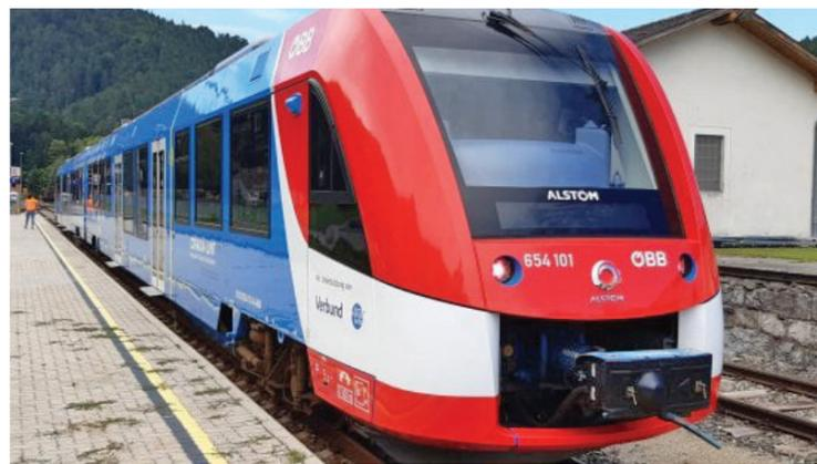
nota in cui annuncia l'ottenimento della commessa - saranno dotati di un sistema di propulsione ibrido bi-modale, elettrico e idrogeno, e avranno un'autonomia di 600 Km (grazie appunto all'H2) su tratte ferroviarie non elettrificate. Saranno costituiti da 4 carrozze, per una lunghezza totale di 72 metri e potranno trasportare 218 passeggeri.
