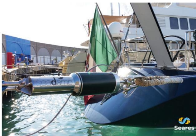
LIVORNO – Seares, startup innovativa toscana attiva nel settore degli accessori per la nautica, con il supporto di Zerynth ha creato un ormeggio intelligente abilitato per l'IoT che cattura l'energia del moto ondoso per trasformarla in energia elettrica, riducendo l'impatto ambientale, creando energia 100% green, aumentando i ricavi del 12% e riducendo del 10% i tempi di sviluppo.
