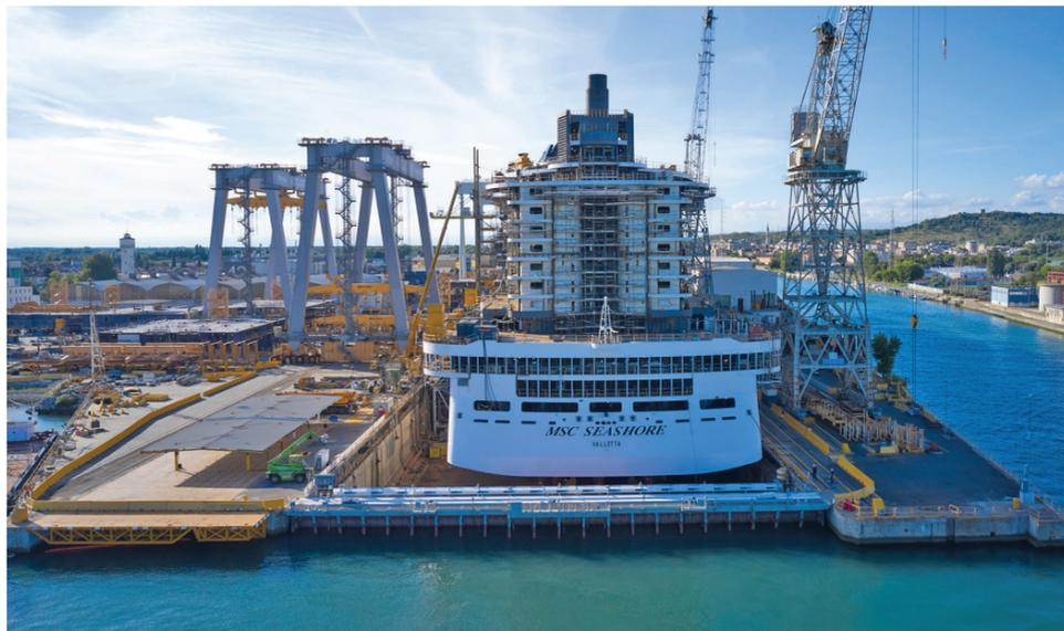
GINEVRA – Giovedì scorso presso lo stabilimento Fincantieri di Monfalcone si è tenuto il float out di MSC Seashore. Un momento particolarmente importante nel processo di costruzione della nave, ovvero quando la nave tocca l'acqua per la prima volta per poi proseguire nelle successive fasi della costruzione.
