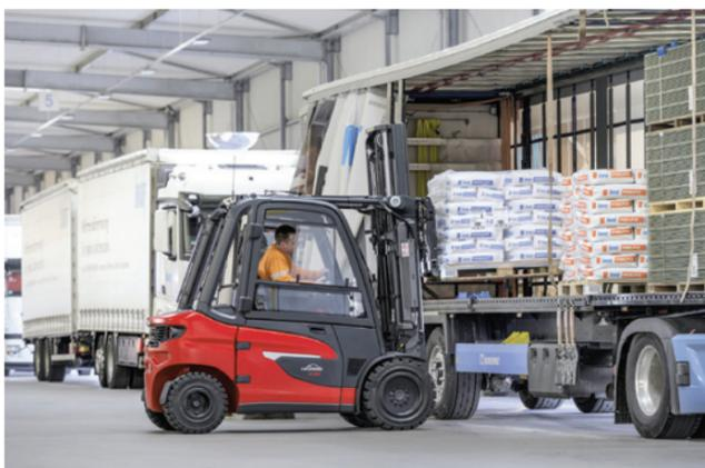
MILANO – I nuovi carrelli elevatori frontali elettrici Linde X20 ed X35, con portata da 2 a 3,5 tonnellate, sono i primi carrelli elettrici che eguagliano prestazioni e robustezza in applicazioni gravose, tipiche dei carrelli termici, offrendo tutti i vantaggi ambientali del funzionamento elettrico.
