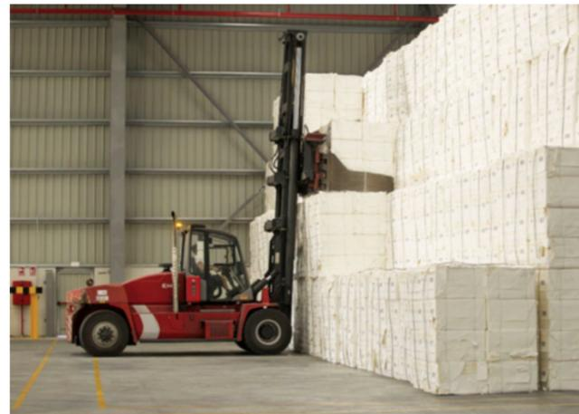
La struttura del telaio e delle ganasce forte e robusta con portata 10.000 kg a baricentro 800 mm, unitamente ad una vasta scelta di configurazioni delle ganasce e di opzioni di aggancio, consente una movimentazione efficace da 1 a 6 balle di cellulosa di tutte le dimensioni. Montate su carrelli elevatori 12 ton, le pinze sono utilizzate per la movimentazione di
