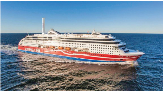
Nella foto: Il traghetto Viking con un propulsore Flettner (il grosso tubo verticale a poppa).
