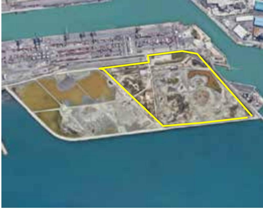
La superficie interessata è di circa 330000 mc e l'intervento prevede la realizzazione di un piano inclinato a doppia falda dalla quota +3,5/4m a +5,5m
